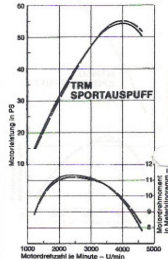
**mot-Urteil:** Ohne Mustergutachten keine Betriebserlaubnis, beim TÜV problematisch; Phonmessung kann verlangt werden. Das Leistungsplus im oberen Drehzahlbereich kann diesen Nachteil kaum aufwiegen.
