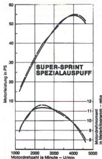
**mot-Urteil:** Ohne Mustergutachten keine Betriebs-erlaubnis, beim TÜV problematisch; Phonmessung kann verlangt werden. Geringfügiges Leistungsplus erst ab 4000 U/min bringt nur in dem Teilbereich eine schwach bessere Fahrleistung.
