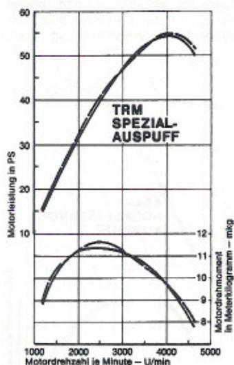
PS mehr, bei 4600 U/min ca. 1 PS mehr. Auch in dem Teilbereich ist nur schwach bessere Fahrleistung möglich.
