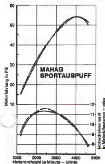
**mot-Urteil:** Nur magere Mehrleistung, in der Fahrleistung ist nur schwache Verbesserung zu erwarten. Die Anlage wird bei Tuninganspruch erst mit Zweivergasieranlage (TDE oder AutoGerma, Auskunft vom Auspuffhersteller einholen) interessant.
