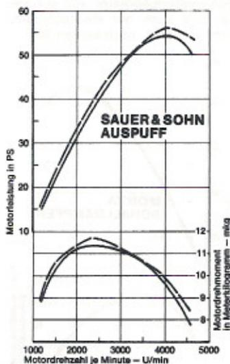
U/min) knapp 1,6 PS ausmacht und bei 4600 U/min sogar gut 3 PS erreicht. Bei sportlichem Ausfahren der Gänge wird ein leichtes Leistungsplus spürbar.
